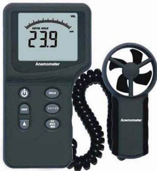
L' anemometro AM836 è uno strumento professionale semplice da utilizzare ed in grado di misurare la velocità e la temperatura dell'aria. Questo strumento è ideale sia per analisi ambientali che per il controllo di impianti di condizionamento e riscaldamento. La ventola separata, con cavo allungabile, permette di eseguire misurazioni in condotte e prese d'aria. La retroilluminazione del display LCD ne consente l'utilizzo in ambienti poco illuminati.
